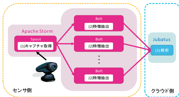
図 4 実装する Apache Storm を用いたフレームワークの概要
