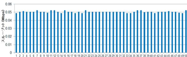
図 12 独自の TCP における端末数 50 台の移動時スループット
