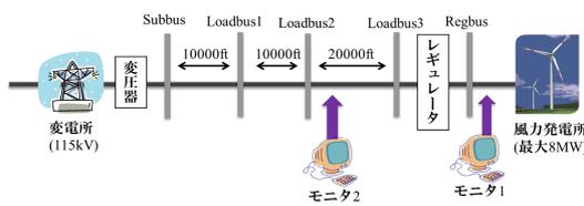
図 2: 基本的な風力発電の配電網
